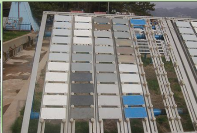
暴露的试验架
